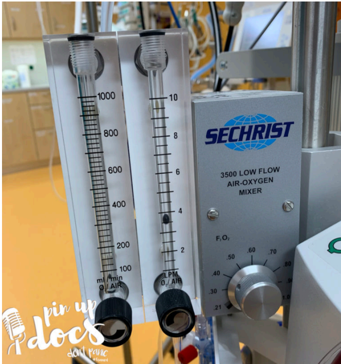
Flowmeter des Gasfluss links und FiO 2 -Regler rechts – Bildmaterial: Klinik für Anästhesie und Intensivtherapie Universitätsklinikum Marburg, D.M.Spies
